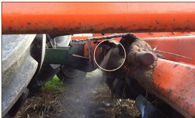
Fraise équipée d'un système de pulvérisation
