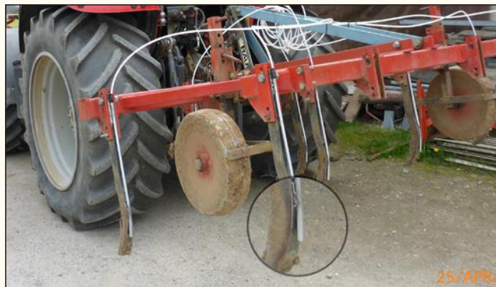
Cultivateur avec un dispositif d'injection derrière les dents
